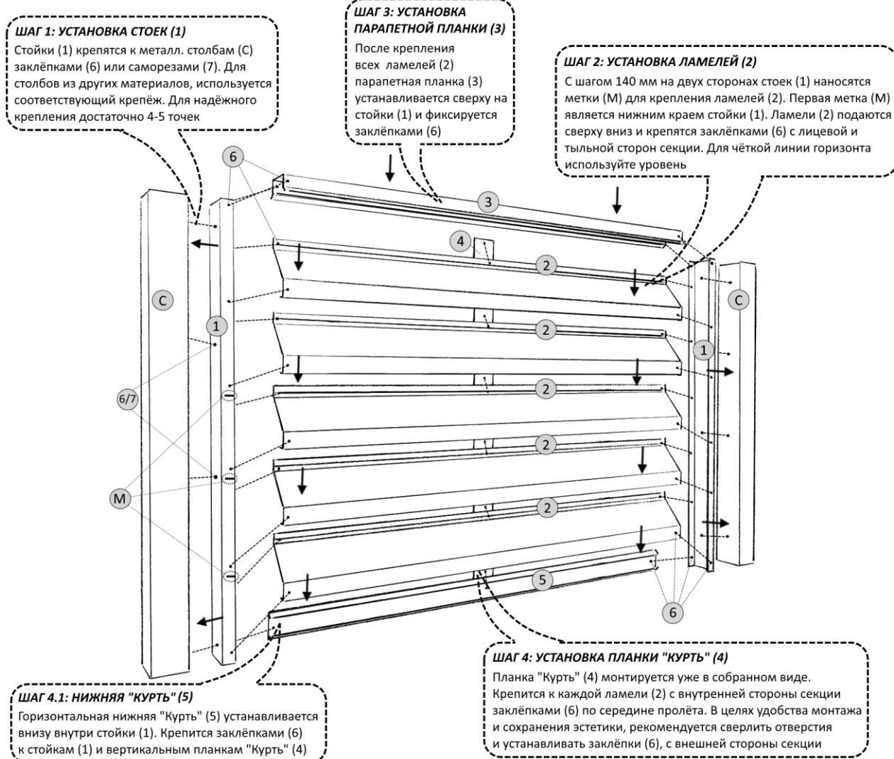
\*допускается другой вид крепежа, например саморезы ПШ или металл-металл 5,5x19, но при этом теряется эстетика внешнего вида и качество сборки
